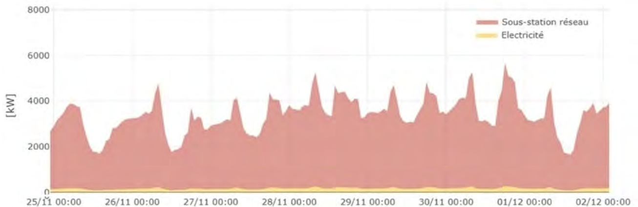
Figure 2 - Puissance appelée par source sur une partie du réseau pour une semaine d'hiver
