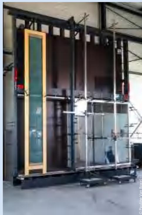
Banc d'essais Air-Eau-Vent pour éléments de façades.
