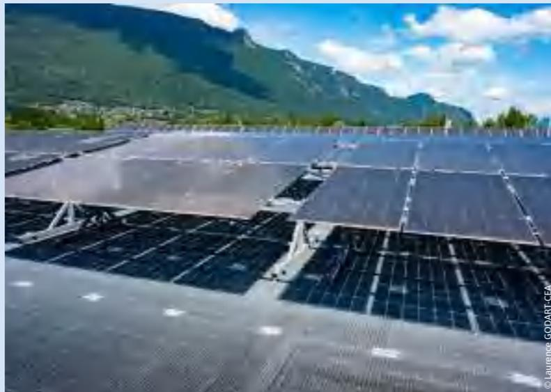
Notre plateforme de test des modules photovoltaïque sur le toit de l’INES permet de suivre le vieillissement des panneaux en conditions réelles.
