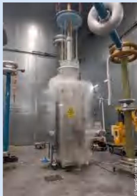
Le RSFCL lors de tests de configuration, dans la plateforme d'essais haute tension de SuperGrid Institute.
